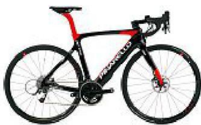
Pinarello Nytro. Telaio in carbonio basato sul modello Dogma F10, peso 13 kg, freni a disco, motore e batteria Yamaha. Prezzo: 6.250 euro
